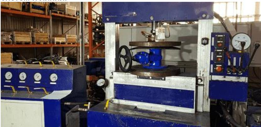
Рис. 4 Испытания на герметичность
