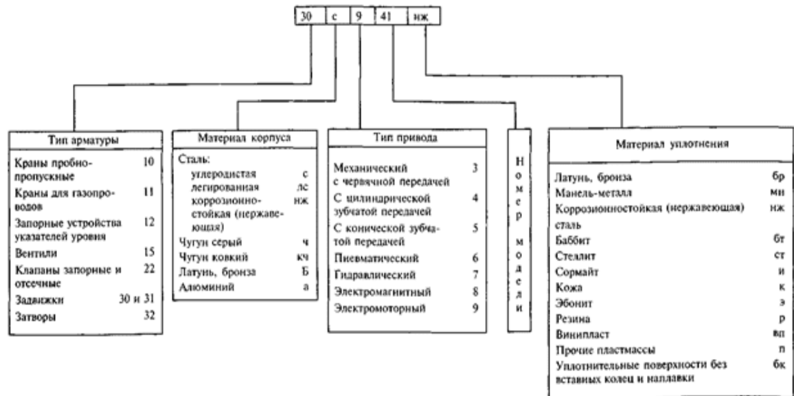
Рис. 1 Маркировка трубопроводной арматуры
